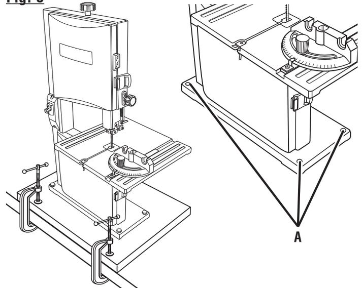
A - Holes in saw base (trous de la base de la scie, orificios de la base de la sierra)
